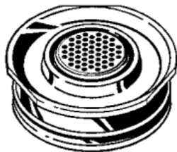
Κάψουλα δοσολογίας τοποθετημένη μέσα στον θάλαμο πλήρωσης
